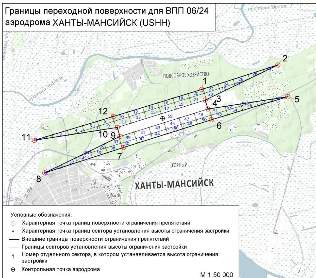
Рисунок 4.2. Схема границ переходной поверхности с учетом летной полосы для ВПП 06/24
