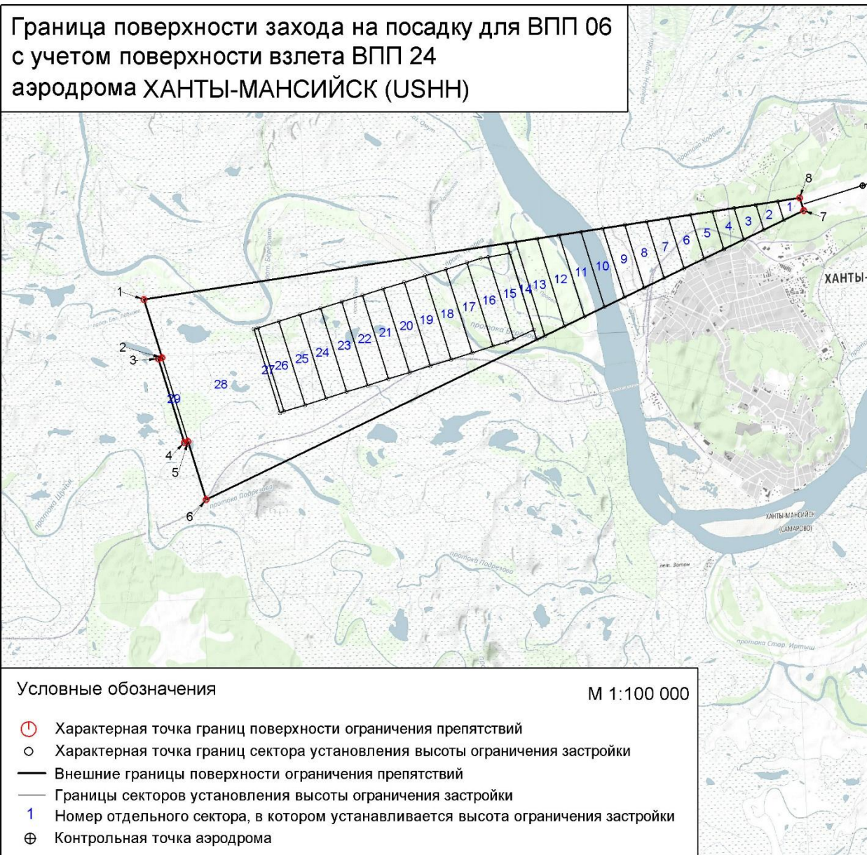
Рисунок 4.3. Схема границ поверхности захода на посадку для ВПП 06 с учетом поверхности взлета ВПП 24
