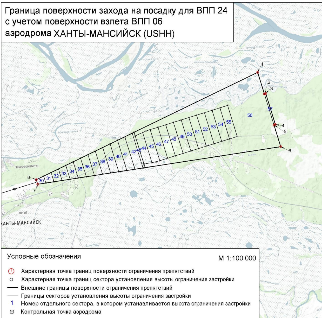
Рисунок 4.4. Схема границ поверхности захода на посадку для ВПП 24 с учетом поверхности взлета ВПП 06
