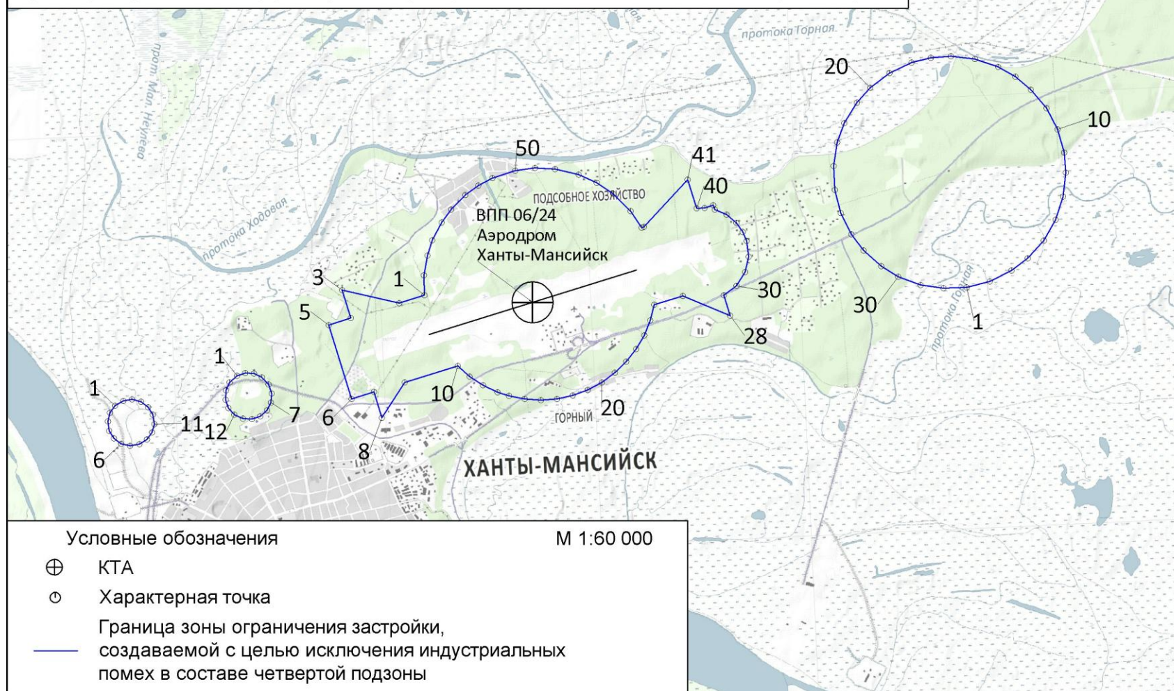
Рисунок 5.2. Схема границы зоны ограничения застройки, создаваемой с целью исключения промышленных помех в составе четвертой подзоны приаэродромной территории
